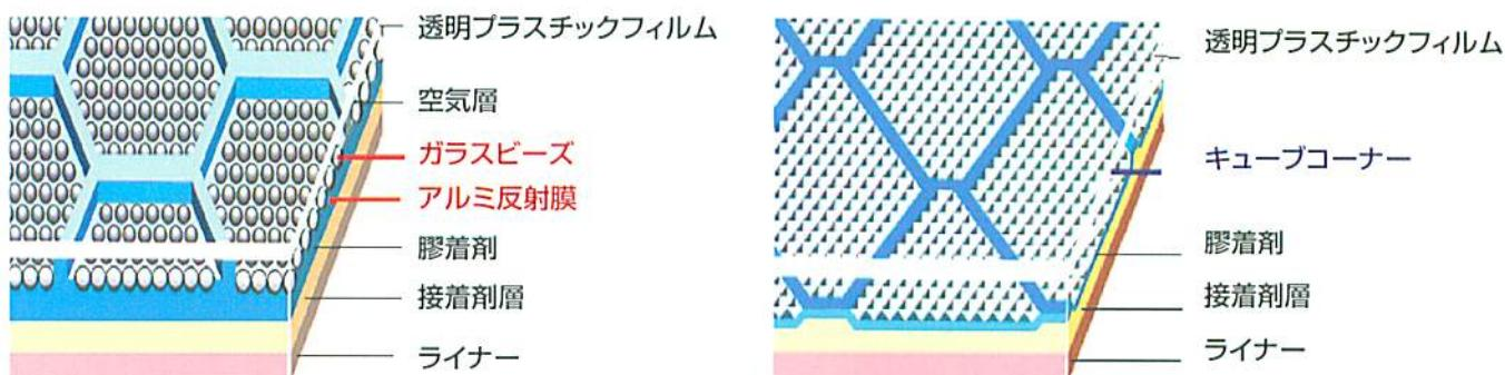
カプセルレンズ型と広角プリズム型はともに再帰性反射材であるが、構造が異なります。カプセルレンズ型はアルミの反射膜とガラスピースが使用されているが、これを使用しない広角プリズム型は材料、生産、加工、廃棄の過程で大幅なCO<sub>2</sub>削減が可能となります。
