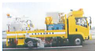
排水性舗装に「ミストライン」作業の安全性向上(中型自走施工機)
