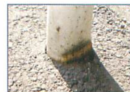
曲げ変形による局所的な腐食による発錆(評価9)
