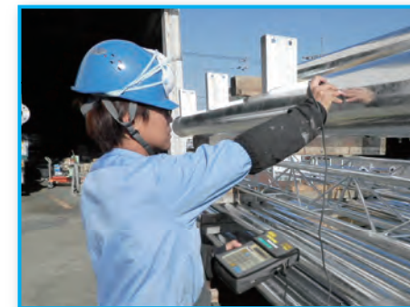
電磁式膜厚計によるめっき及び塗装の膜厚計測
