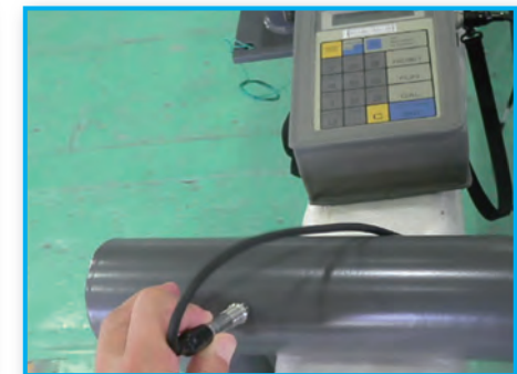
電磁式膜厚計によるめっき及び塗装の膜厚計測
