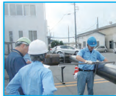
ノギスによる外径計測
