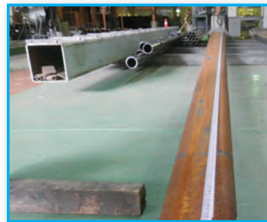
鋼製巻尺による長さ計測
