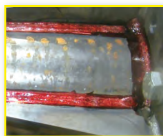
浸透探傷試験による表面割れ有無の確認
