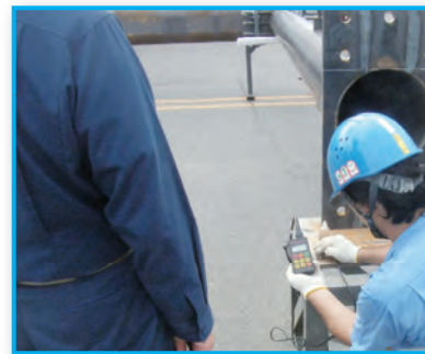
超音波厚さ計による肉厚計測
