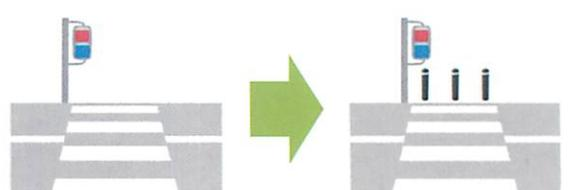
コーナー部に歩行者保護と見通しに配慮したガードパイプを設置し、より強固に安全対策を行うプランです
