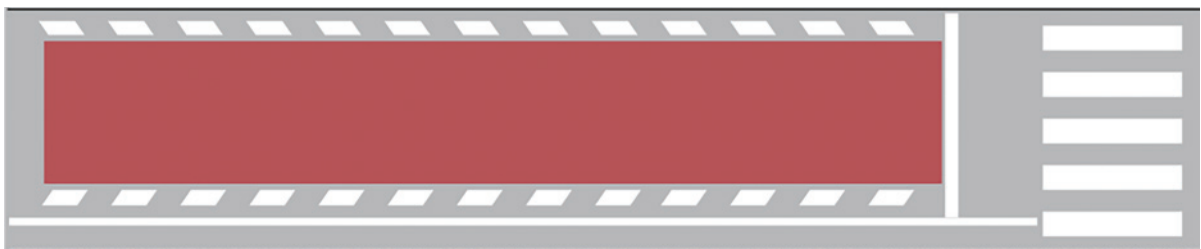
イメージ② すべり止め舗装と減速ドット
